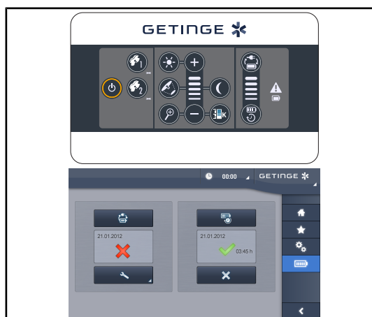
Fig. 52: Test di commutazione all'alimentazione di backup
