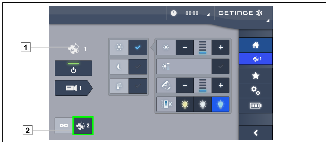
Fig. 62: Synchronisation der Leuchten
