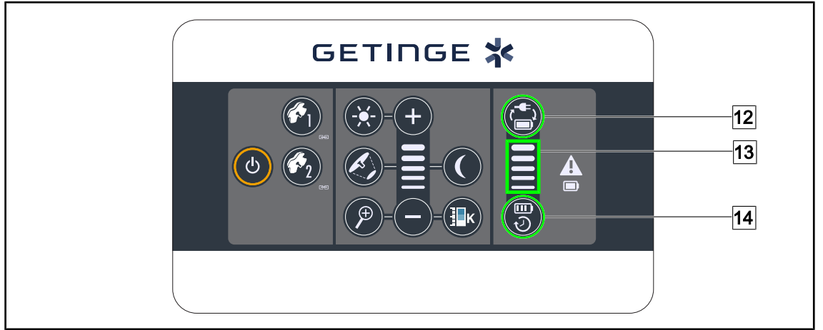
Şek. 130: Duvar klavyesinden batarya testleri
