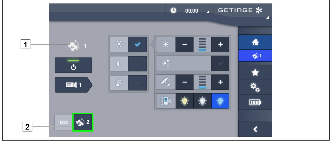
Şek. 62: Lamba başlıklarının senkronize edilmesi
