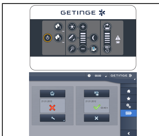
Rys. 52: Test przełączenia na system awaryjny
