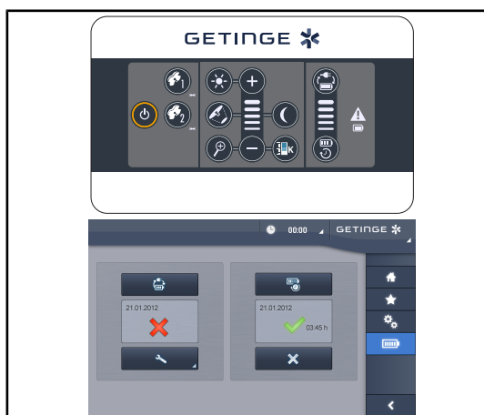
Fig. 52: Test for overgang til hjelpestrøm
