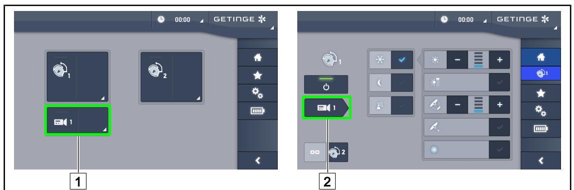
Fig. 30: Einschalten der Kamera
