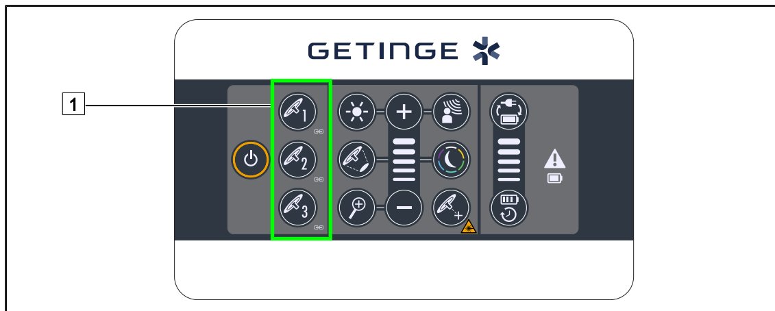
Rys. 60: Synchronizacja kopuł za pomocą ściennego panelu sterującego
