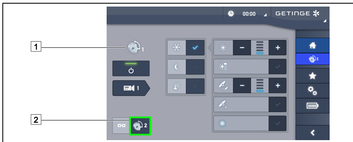
Obr. 61: Synchronizácia na kupolách
