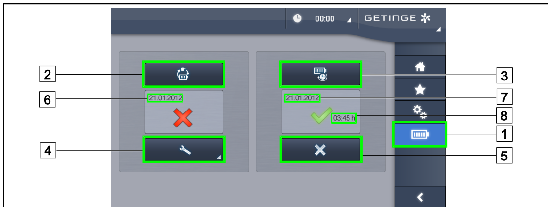
131. ábra Akkumulátorok tesztje
